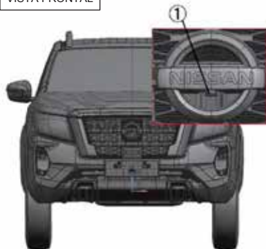
Cámara frontal para el monitor de vista periférica 1. Posición de la cámara
