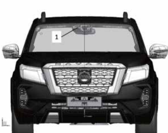
Posición de la cámara de intervención inteligente de cambio de carril 1. Posición de la cámara
