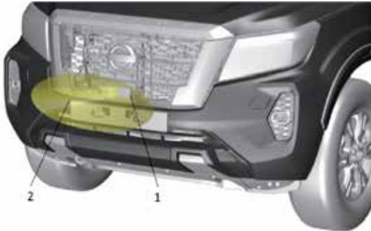
Posición del sensor inteligente de frenado de emergencia 1. Posición del sensor 2. Embudo de señales
