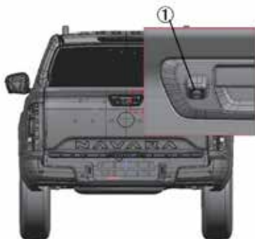
Cámara trasera para monitorización de la vista periférica 1. Posición de la cámara
