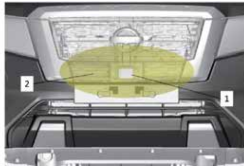
Posición del sensor inteligente de frenado de emergencia (vista frontal) 1. Posición del sensor 2. Embudo de señales
